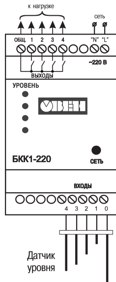
Рисунок 5.4 – Схема подключения БКК1-220
